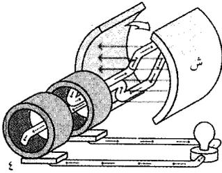
٣- عندما تدور الحافظة موازية للمجال المغنطيسي (إلى اليمين) يتوقف تولد التيار في تلك اللحظة. ولا نلاحظ في المنازل التي تستخدم التيار المتناوب هذا التوقف لأنه يحدث بسرعة.
