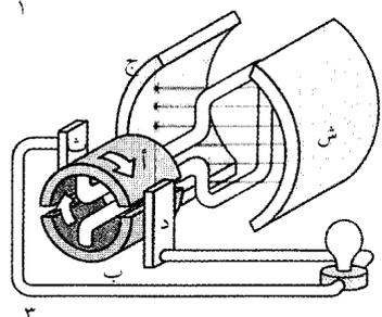
النوع من مولدات التيار المستمر مولدات الاستشارة المنفصلة. ويستخدم العديد من مولدات التيار المستمر جزءاً من التيار المستمر المنتج لتشغيل المغنطيسات الكهربائية اللازمة لها. وتعرف تلك المولدات بالمولدات ذاتية الاستشارة، ويعتمد مولد التيار المستمر ذاتي الاستشارة على المغنطيسية المتبقية، وهي جزء صغير من المغنطيسية يتبقى في المغنطيس الكهربائي بعد توقف المولد. ولولا وجود تلك المغنطيسية لكان من المحال تشغيل المولد ذاتي الاستشارة بعد توقفه.
