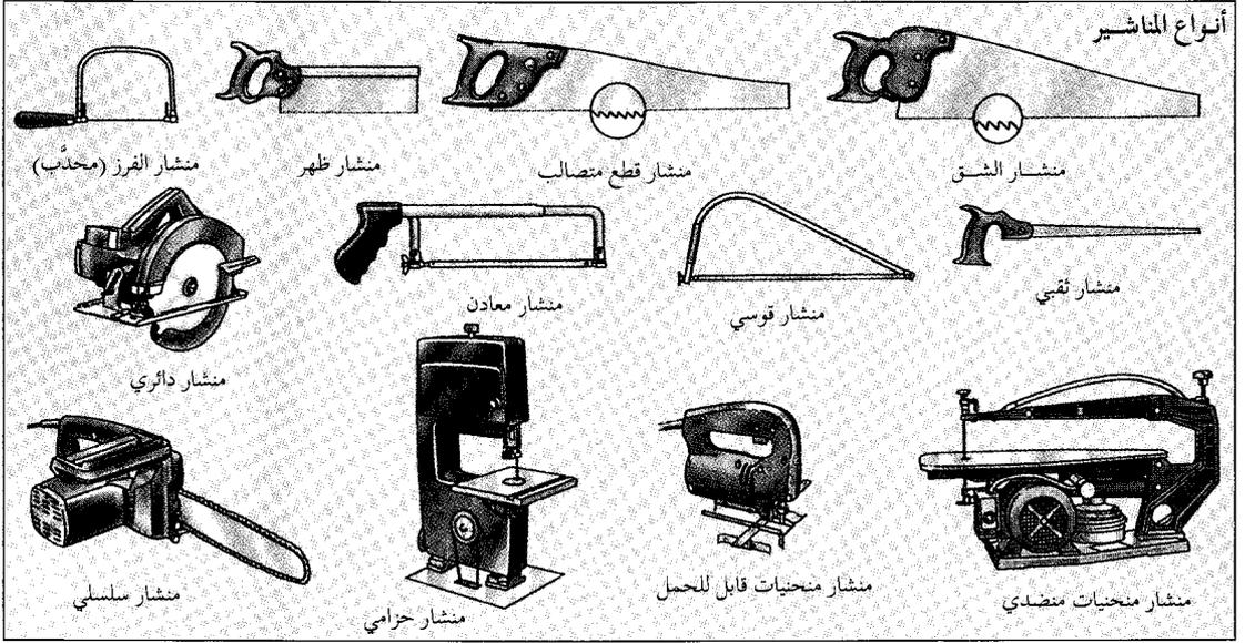
المنشئيل الآلية. تُدار بواسطة محرك كهربائي أو محرك يدار بالبتترول. ويثبت بعضها على حامل خاص، ويمسك بعضها الآخر باليد. ويمكن تركيب مختلف أنواع النصال على غالبية المنشئيل الآلية لقطع مواد متنوعة. ويتحرك نصل المنشار بسرعة كبيرة، ولذلك ينبغي استعمالها بحرص وحذر شديد.
