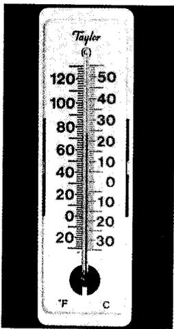
المقياس المثوي شائع الاستعمال، ويستخدم في قياس درجة الحرارة، ويرصد الترمومتر مزدوج التدرج (أعلاه) قراءتين؛ مغوي وفهرنهايتي.
