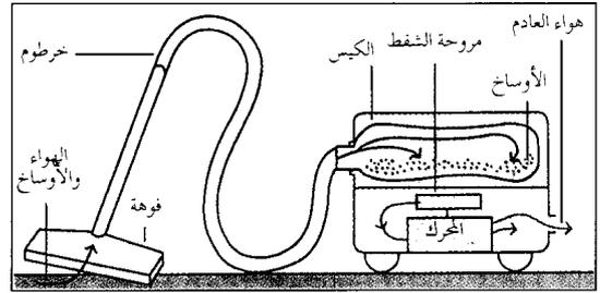
يوضح الشكلان النوعين الرئيسيين للمكناس الكهربائية وهما النوع ذو الحوض أو الصهريج والنوع العمودي. ففي النوع ذي الحوض (أعلى) تقوم مروحة الشفط بشفط الأوساخ عن طريق خرطوم مرن إلى داخل الكيس. وفي النوع العمودي (أدناه) تقوم مروحة الشفط بشفط الأوساخ المفككة بفعل الخضاضة. وهي أسطوانة دوارة ذات شعيرات.
